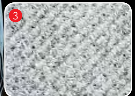
3 Special wool resisting against steel drop casting Trama speciale resistente alla colata di acciaio fuso
